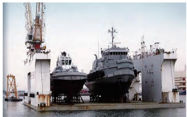
フローティング工法を用いた船舶修繕
