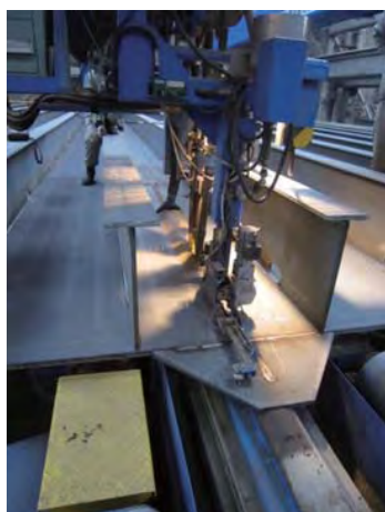
板継用片面自動溶接機（RF法）
