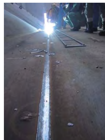
船艙内突合せ簡易自動溶接
