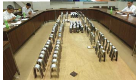
写真は外観審査及び 曲げ試験・判定の様子
