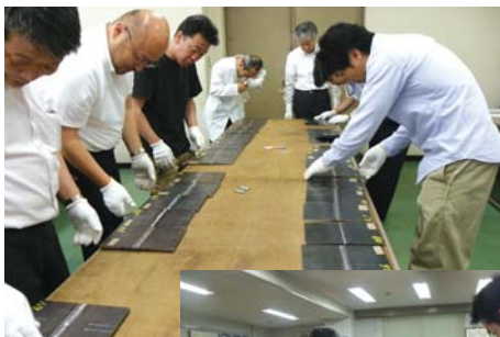
写真は外観審査及び 曲げ試験・判定の様子
