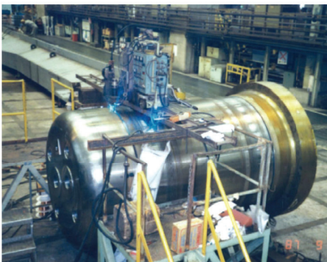
写真1 狭開先自動溶接状況 (1987年)
