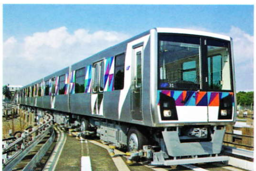
レーザ溶接構体の横浜新都市交通向け 「金沢シーサイドライン YNT2000 型車両」(4)
